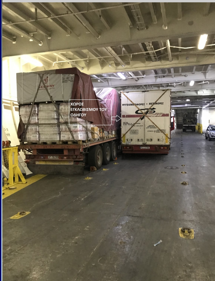
Εικόνα 1: Απεικόνιση του χώρου όπου εγκλωβίστηκε ο οδηγός κατά την διαδικασία σύνδεσης Ελκυστήρα και Επικαθήμενου.
