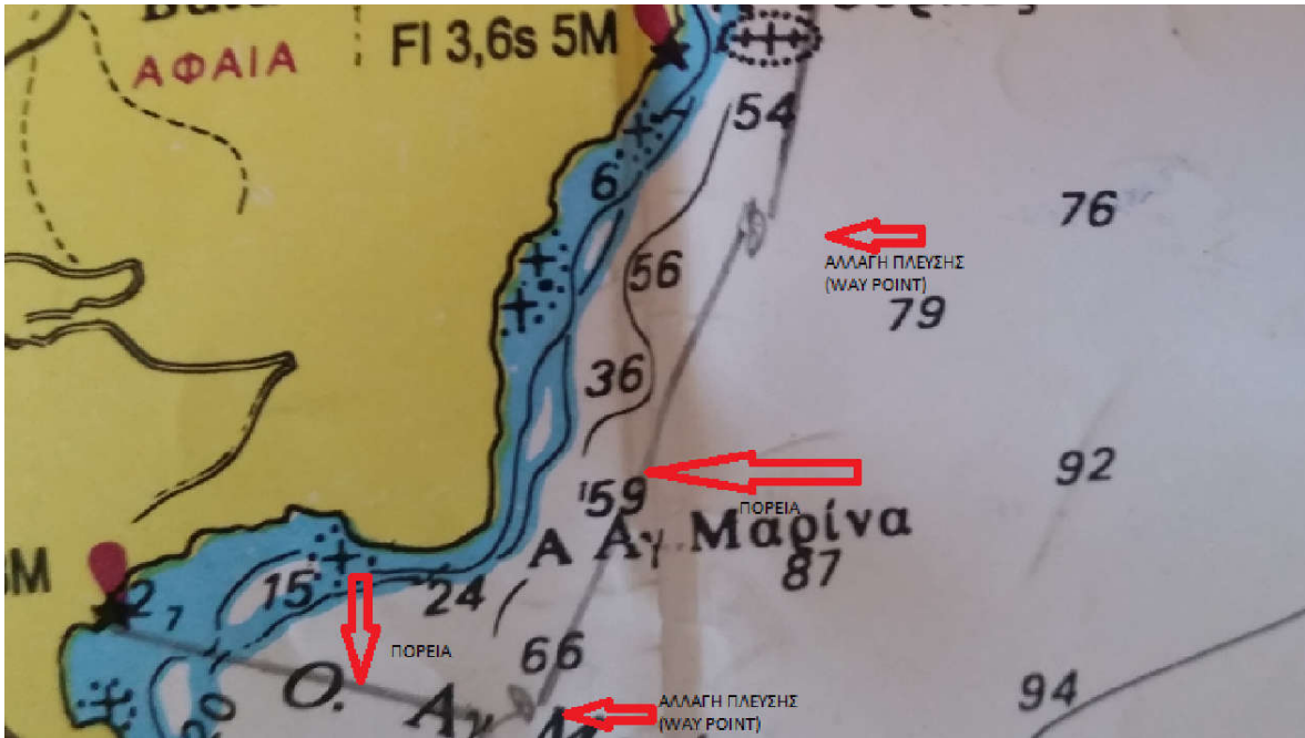
Εικόνα 24: Μέρος της υποτυπωμένης στο ναυτικό χάρτη πορείας του ΑΛΕΞΑΝΔΡΟΣ από το τρίτο τμήμα του ταξιδιού του στο τέταρτο, με το σημείο αλλαγής πορείας (waypoint), έξωθεν του λιμένα της Αγίας Μαρίνας.
