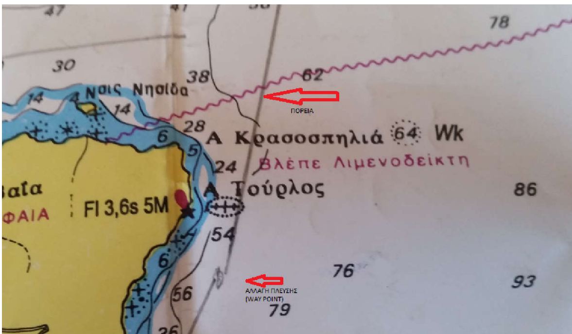
Εικόνα 23: Μέρος της υποτυπωμένης στο ναυτικό χάρτη πορείας του ΑΛΕΞΑΝΔΡΟΣ από το δεύτερο τμήμα του ταξιδιού του στο τρίτο, με το σημείο αλλαγής πορείας (waypoint), ΝΝΑ της Άκρα Τούρλος.
