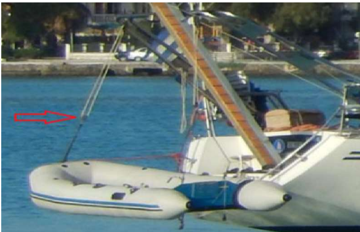
Εικόνα 7: Απεικόνιση παρόμοιου τύπου συγκράτησης κοινής λέμβου
