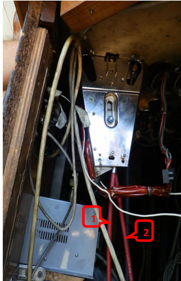
Εικόνα 4: άποψη του μοχλού ελέγχου φοράς κίνησης όπου σημειώνονται και οι ενδεικτικοί λαμπτήρες θέσης (εντός κόκκινου κύκλου)
