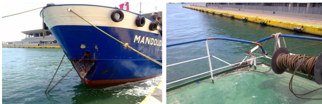
Εικόνες 2,3: Οι ζημιές οι οποίες διαπιστώθηκαν στο Δ/Ξ ΜΑΝΤΟΥΔΙ εξωτερικά (αριστερά: εμπρόσθιο τμήμα, δεξιά: χειραγωγό δεξιού καταστρώματος γέφυρας)
