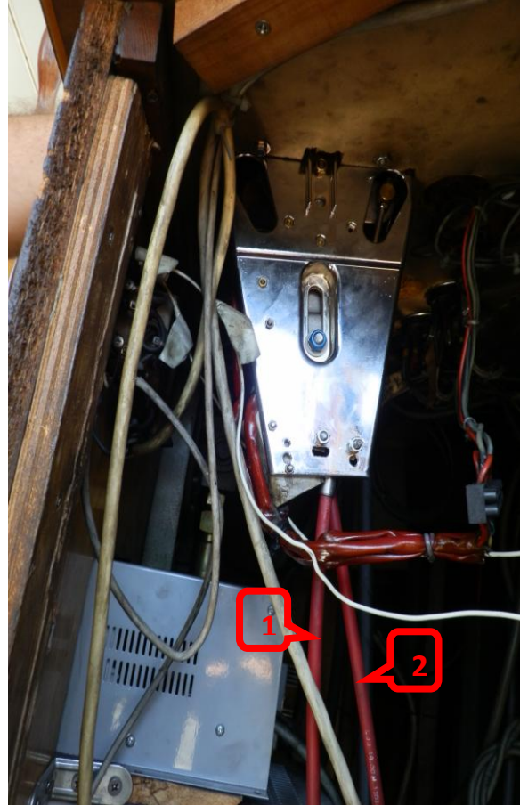
Εικόνα 5: άποψη του κάτω μέρους του χειριστηρίου, όπου σημειώνονται οι έξοδοι των συρματόσχοινων προς το μηχανοστάσιο. 1: έξοδος ντίζας αλλαγής φοράς κίνησης μηχανής 2: έξοδος ντίζας ρύθμισης στροφών μηχανής
