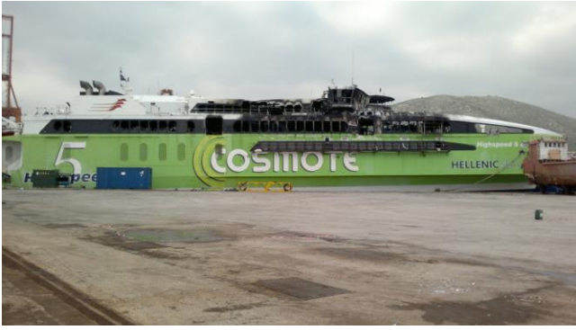
Εικόνες 2 & 3: Γενική άποψη της δεξιάς και της αριστερής πλευράς του πλοίου αντίστοιχα, στην οποία φαίνονται οι εκτεταμένες ζημιές από την πυρκαγιά.
