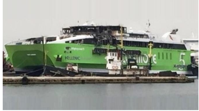
Εικόνες 2 & 3: Γενική άποψη της δεξιάς και της αριστερής πλευράς του πλοίου αντίστοιχα, στην οποία φαίνονται οι εκτεταμένες ζημιές από την πυρκαγιά.
