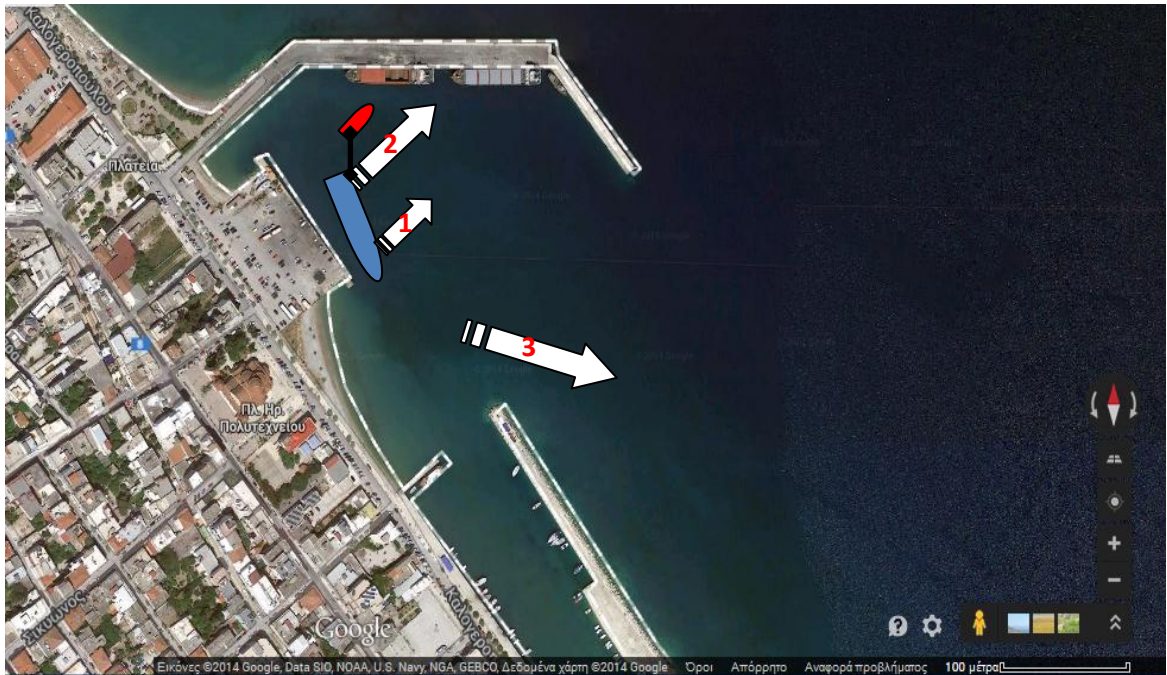
Εικόνα 2: σχεδιάγραμμα των κινήσεων τις οποίες έκανε το «JSM» (γαλάζιο σκάφος): (1) απομάκρυνση της πλώρης από τον προβλήτα με χρήση ιδίων σχοινιών του πλοίου, (2) απομάκρυνση σε μεγάλο βαθμό της πρύμνης του πλοίου από τον προβλήτα λόγω της έλξης του Ρ/Κ (ερυθρό σκάφος), με αποτέλεσμα η κατεύθυνση του πλοίου να μην είναι προς την έξοδο του λιμένα και να διαφαίνεται κίνδυνος προσάραξης στο λιμενοβραχίονα του αλιευτικού καταφυγίου (3) έξοδος από το λιμένα με χρήση μηχανών πρόωσης του πλοίου, παρασύροντας το Ρ/Κ στο βυθό. (Οι διαστάσεις των πλοίων και του ρυμουλκίου δεν είναι υπό κλίμακα. Πηγή χάρτη: GoogleMaps, http://maps.google.com/ )
