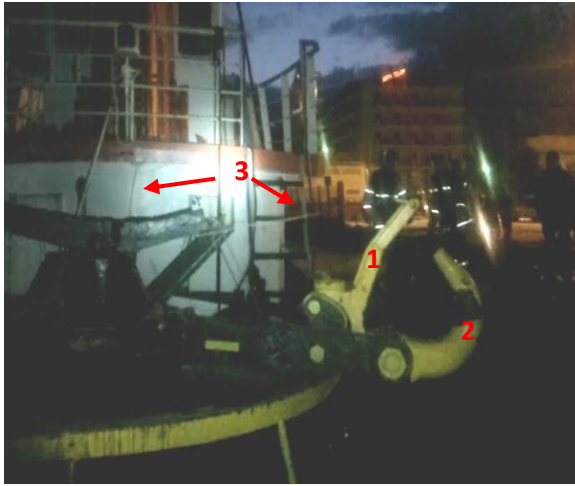
Εικόνα 3: Η διάταξη άμεσης απελευθέρωσης του άγκιστρου ρυμούλκησης του Ρ/Κ «ΑΡΤΕΜΙΣ V». Έχει αποτυπωθεί η κατάσταση πριν (αριστερά) και μετά (δεξιά) την απελευθέρωση. Διακρίνονται: 1: Βραχίονας ασφάλισης άγκιστρου, 2: Άγκιστρο ρυμούλκησης, 3: Συρματόσχοινο απασφάλισης, από το βραχίονα προς το χώρο πηδαλιουχίας.
