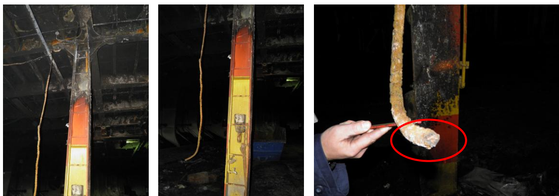
Η πρυμναία πλευρά του στύλου μεταξύ των νομέων 219-221 και το κομμένο καλώδιο.
